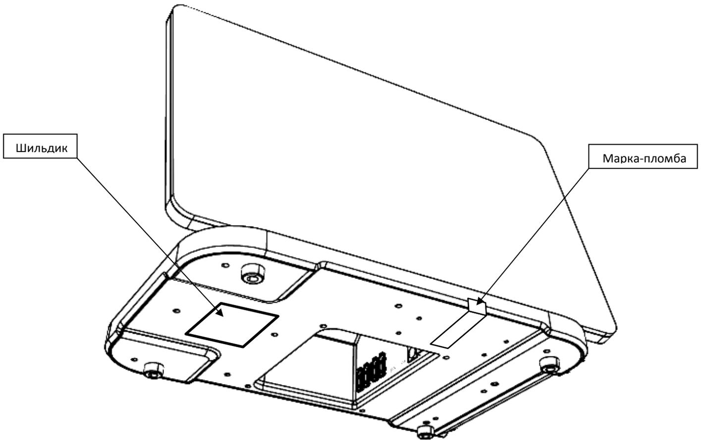
Одна марка-пломба наклеивается на кожух, закрывающий блок управления и устройства печати кассовых чеков так, чтобы было невозможно получить доступ к внутренней части ККТ без разрушения марки-пломбы. Шильдик наклеивается на дно корпуса ККТ.
